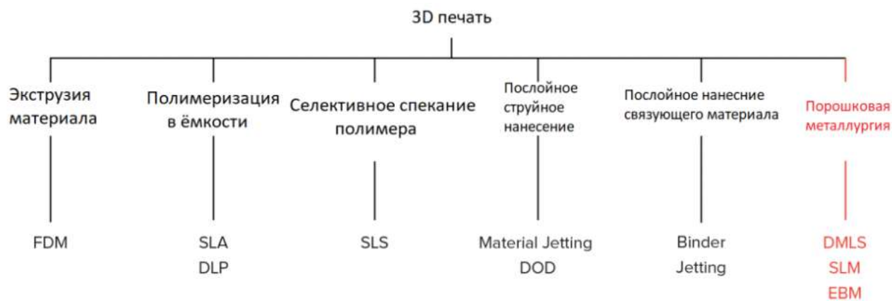
Рис. 1. 3D печать металлами. Аддитивные технологии [3].
