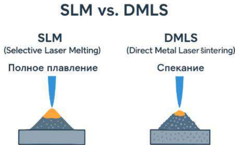
Рис. 2. Разница между полным плавлением и спеканием порошка.
